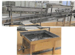
냉각 살수 컨베이어
