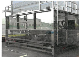
저장 탱크 및 자동 계량, 배출장치
