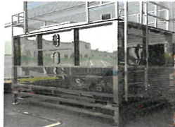
저장 탱크 및 자동 계량, 배출장치
