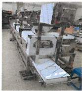
쌀기루 하부 이송 컨베이어
